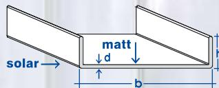
>> Unter der Berücksichtigung dieser hohen statischen Vorgaben und den zu erwartenden hohen Windlasten sowie der Anforderung, dass in der Fassade Sicherheitsglas eingesetzt werden sollte, musste jede einzelne LINIT-Glasbahn zu LINIT tough verarbeitet werden, d.h. thermisch vorgespannt werden und einen Heat-Soak-Test erfolgreich durchlaufen.
